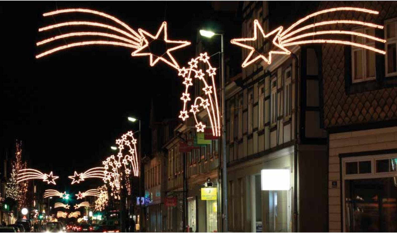
**Vorteile:** Einheitliche Montagehöhe und Abstände sorgen für eine optimale Optik in der Tiefe. Durch das Einsetzen von Steckdosen bei der Erstmontage benötigt man bei den Folgemontagen keine teuren Fachkräfte mehr. Die Mastschellen können ganzjährig am Mast verbleiben – das senkt die Folgekosten.
